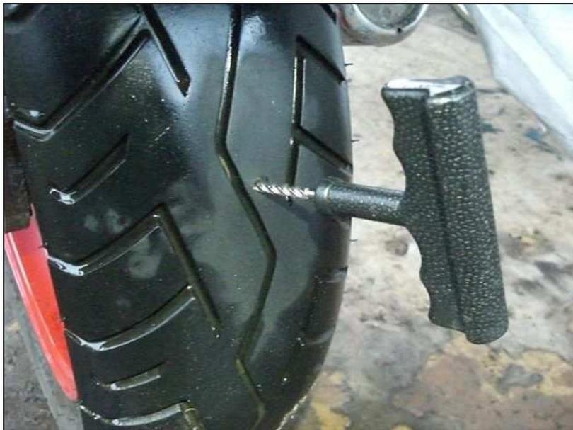
Anschließend habe ich den umliegenden Bereich des Loches mit ein wenig Schleipapier leicht angeraut. So haftet der Dichtstreifen im Oberflächenbereich besser und die Klebverbindung hat eine rauere Struktur.
