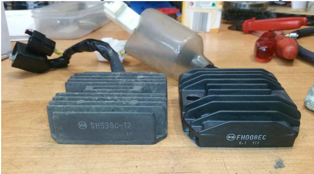
und die unterschiedliche Steckverbinder. In den alten Steckverbinder hat jemand schon mal dickes weißes Fett eingesprüht um die Kontakte zu schützen. Dies darf man NUR mit säurefreies Fett machen!
